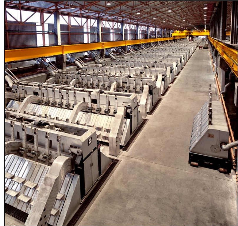
Aluminum Production Hall-Héroult Cells
